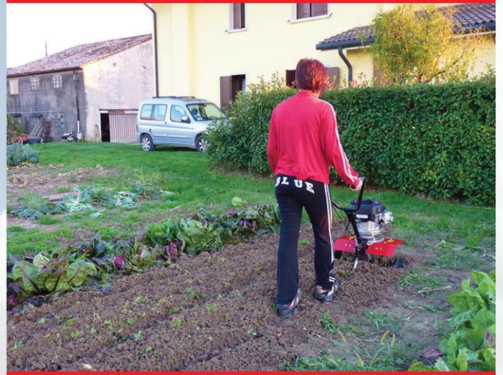
La F41 è una piccola motozappa, adatta per le lavorazioni in piccoli appezzamenti di terreno e in orto. Ha installato un motore da 2,6 KW che la rende nonostante le sue dimensioni ridotte, una macchina potente ed affidabile.
