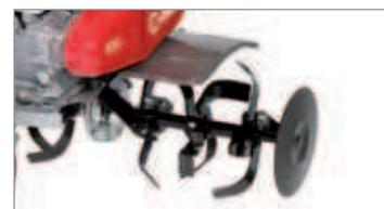
Fresas de 87 cm atornilladas y cuchillas curvas que permiten una óptima penetración aun en terrenos duros.
