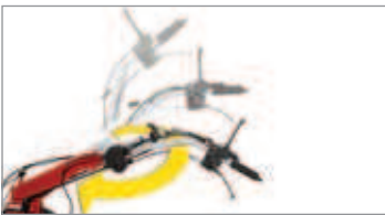
Manillar regulable vertical y horizontalmente, reversible a 180°, con dispositivo antivibración para un uso más cómodo.
