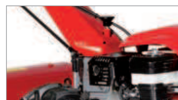
Manillar montado sobre soportes antivibración.
